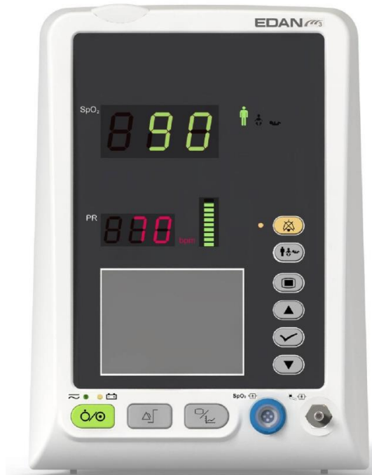
Figure 3-6 Affichage en mode de SpO 2 uniquement
