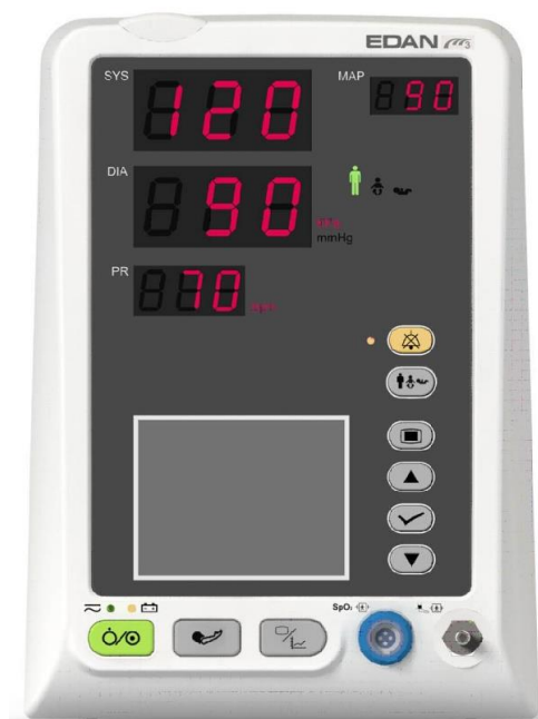
Figure 3-7 Affichage en mode de PNI uniquement
